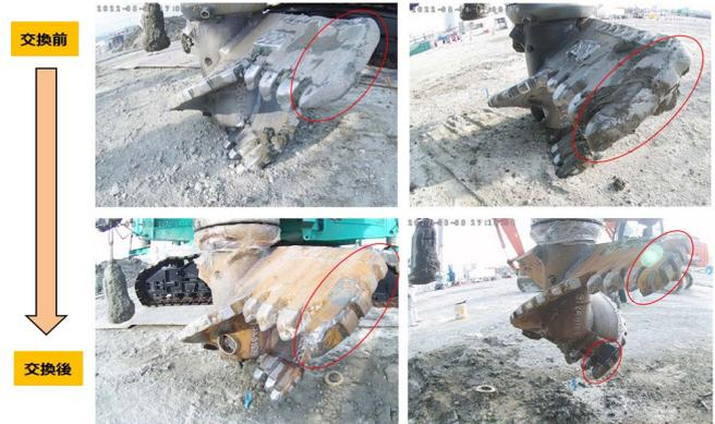
写真-6 攪拌ビットの交換前後
