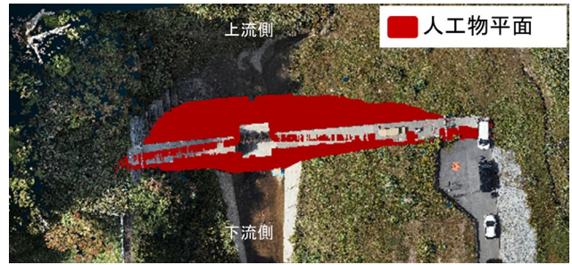
図-4 RANSAC法による砂防設備の抽出結果
