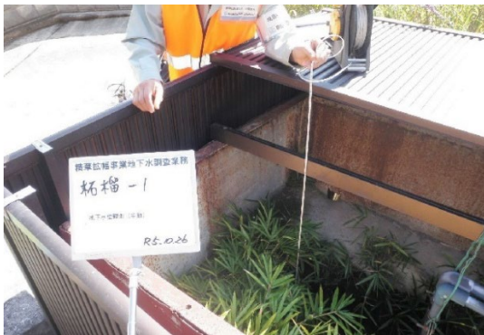
写真 2 地下水位観測状況
