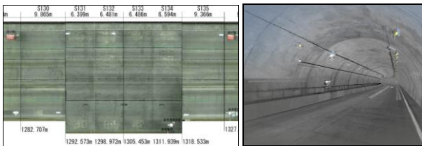
図-3 覆工データ 左：画像展開図 右：点群データ
