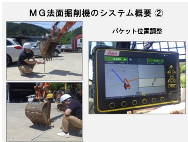
図-7 バケットの爪先調整
