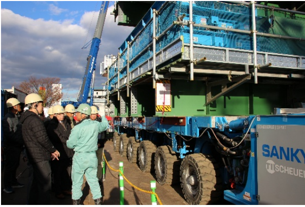
図-12 現場にて多軸式特殊台車を見学
