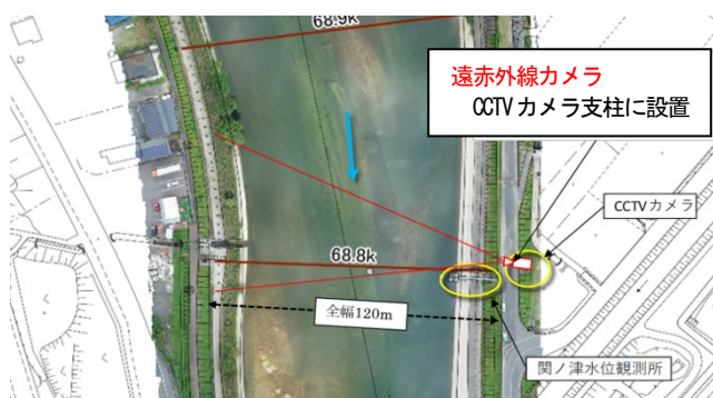
図-2 観測機器（遠赤外線カメラ）の設置位置
