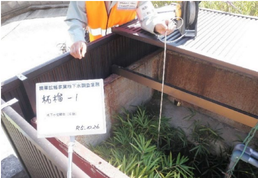
写真 2 地下水位観測状況
