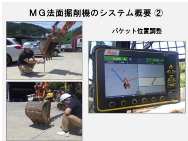
図-7 バケットの爪先調整
