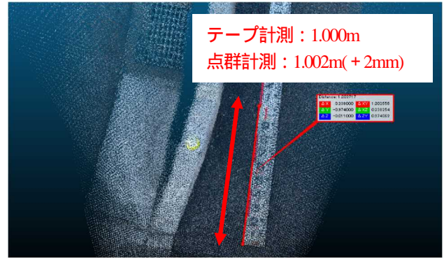
図-3 計測精度の検証 (リボンテープ延長との比較)
