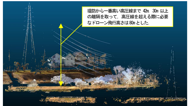
図-3 調査地内の高圧線(3Dスキャナによる点群)
