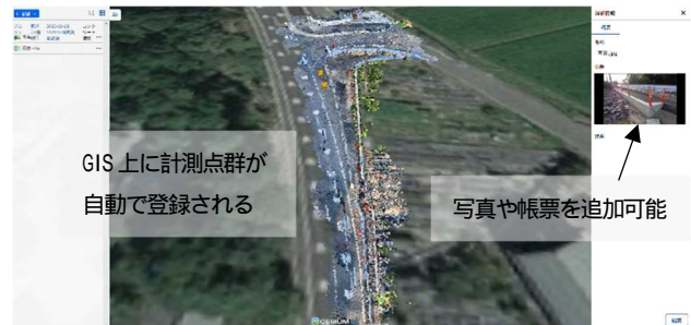
図-6 Geo Log機能によるGIS上での道路補修業務の管理
