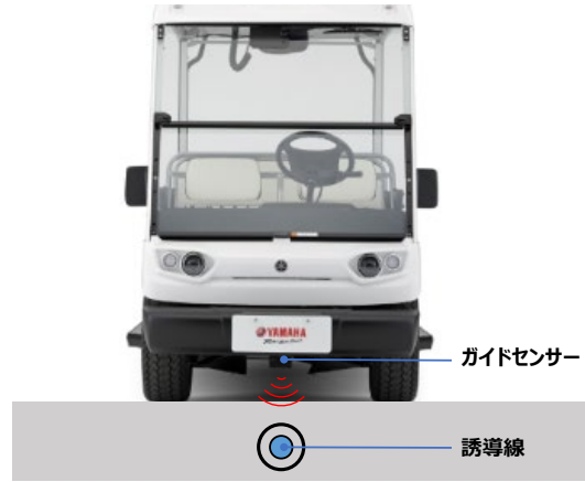
図-8 自動運転の仕組み
