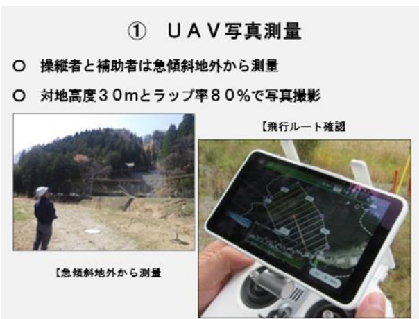
図-3 UAV写真測量状況
