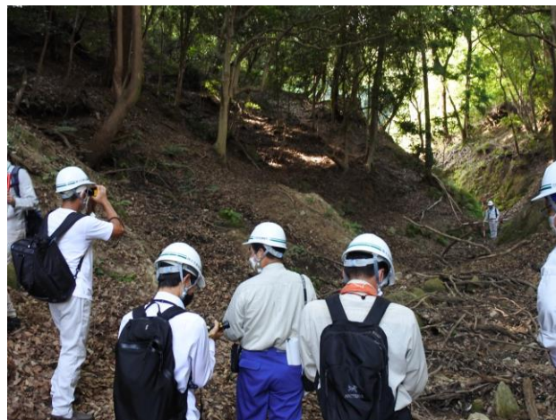
写真-3 溪流調査 (レーザー測距儀による距離測定)
