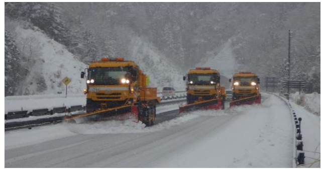
写真-4 梯団除雪の様子
