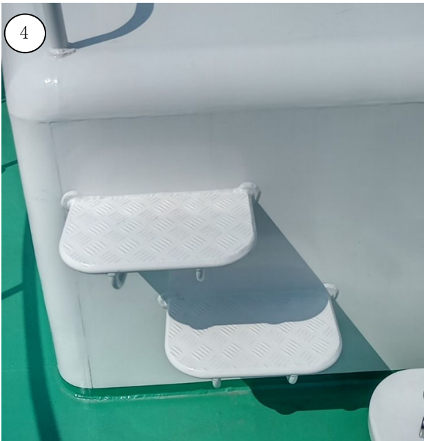
写真6 操舵室前方昇降用ステップ
