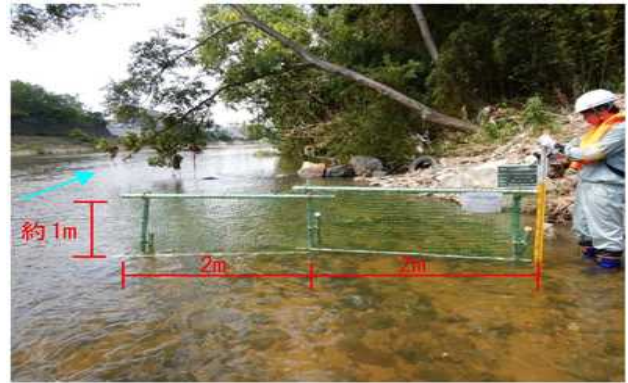
図-3 流下ゴミを捕捉する装置
