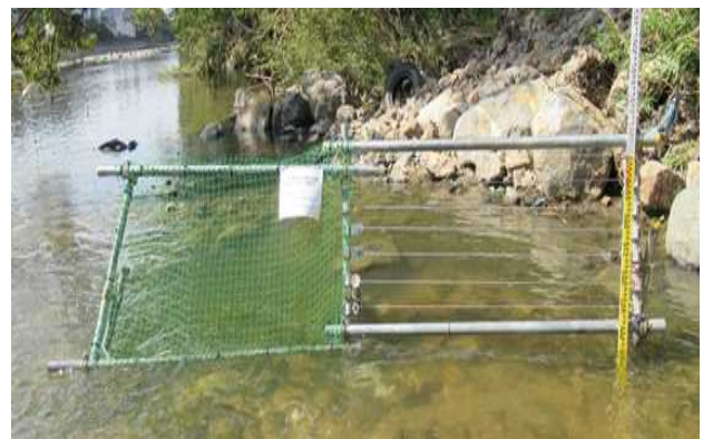
図-4 ネットと番線による捕捉装置
