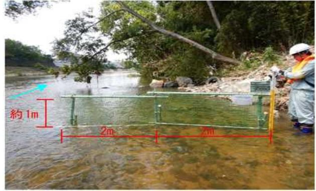
図-3 流下ゴミを捕捉する装置
