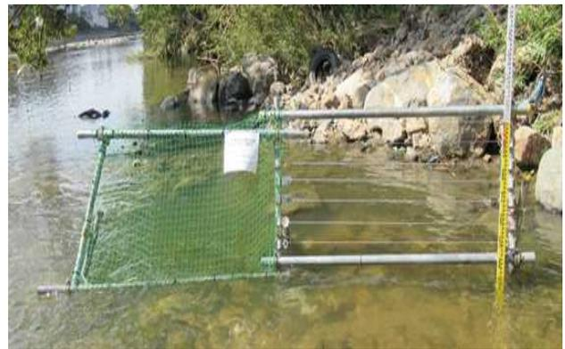
図-4 ネットと番線による捕捉装置
