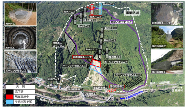
図-10 対策工の実施状況(2023年3月末時点)
