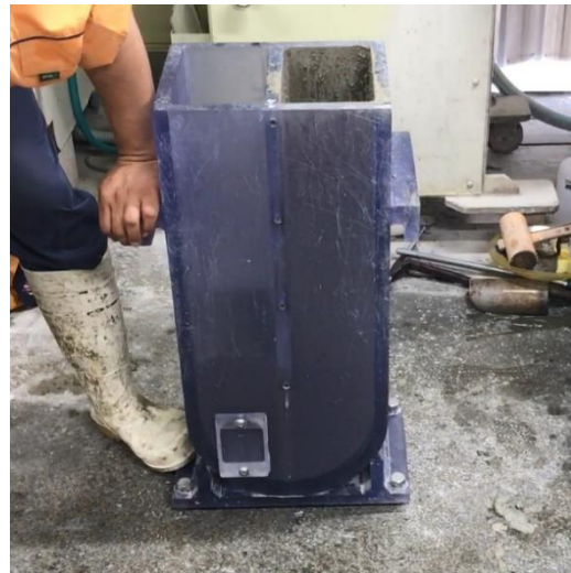
写真-1 U型充填試験の様子
