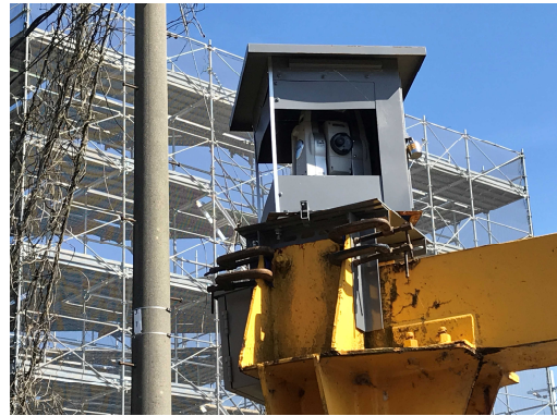
写真-1 トータルステーション
