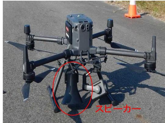
(写真-3 スピーカー搭載ドローン)
