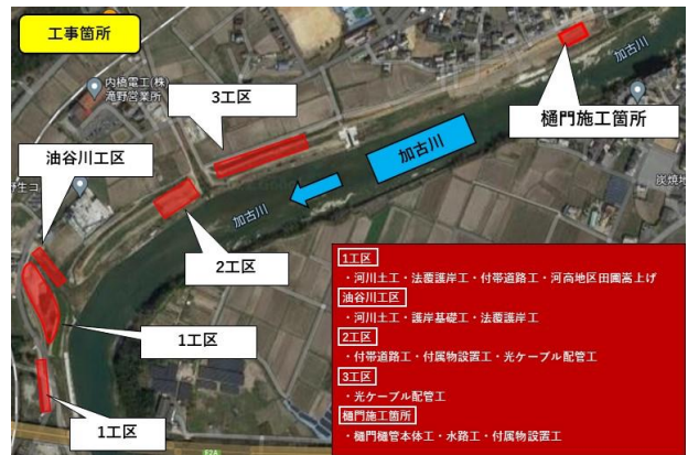
図-2 対象工事の工事概要
