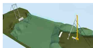
①鉄塔、引張アンカー設置
