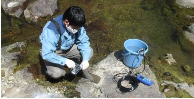
写真-2 現地作業状況(採水とフィールドデータ測定)
