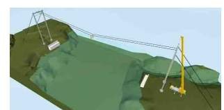
②ケーブルクレーン設置
