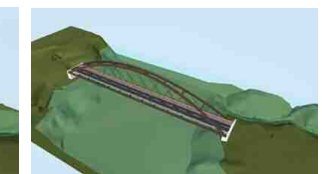
⑥橋面を施工し完成
