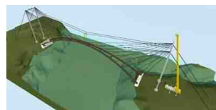
③アーチリブの架設、閉合
