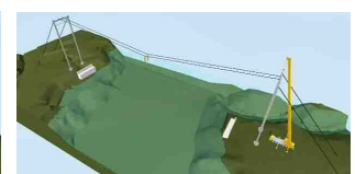
②ケーブルクレーン設置
