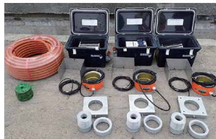
図-13 アンカー荷重計 (SAAM-L)
