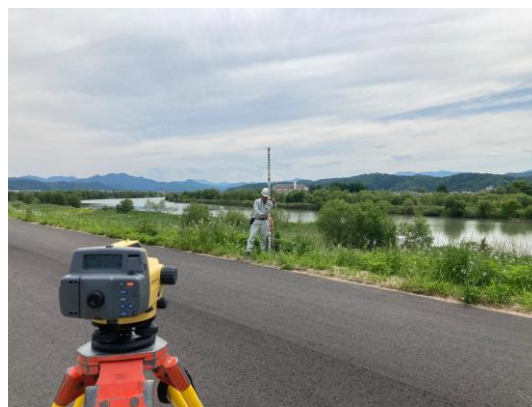
図-6 水準測量の様子(円山川右岸)
