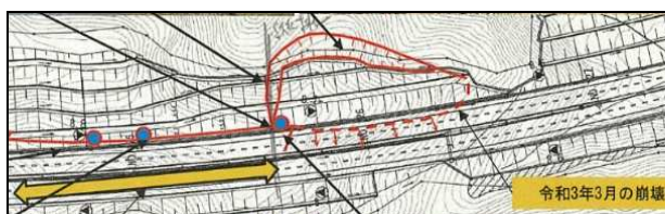
図-7 白色凝灰岩の出現位置
