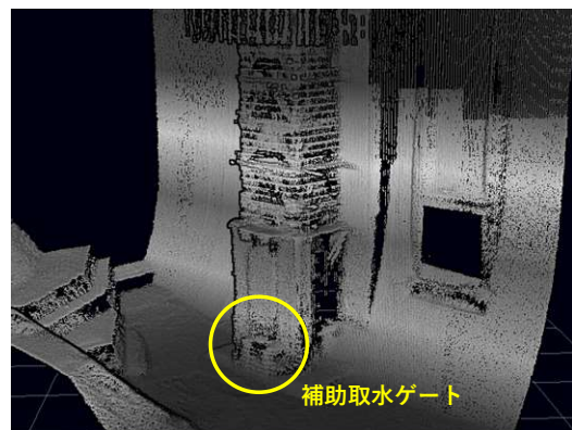
図-7 マルチビーム測深機による計測
