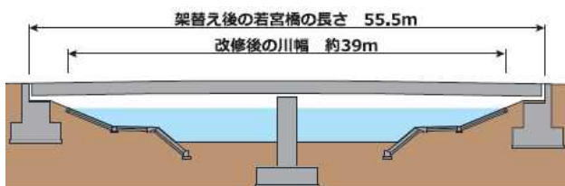
図-2 架け替え後の若宮橋の長さ55.5mと改修後の川幅
