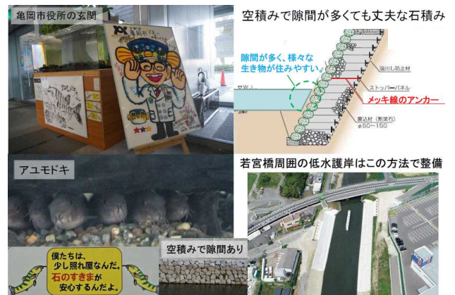
写真-4 市の魚「アユモドキ」と生態系に配慮した低水護岸
