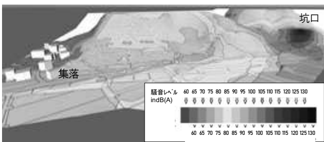
<図-6> 3次元騒音解析結果（発破騒音・昼間/無対策）
