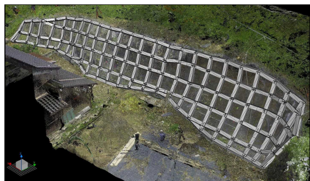
図-3 3次元法枠モデル
