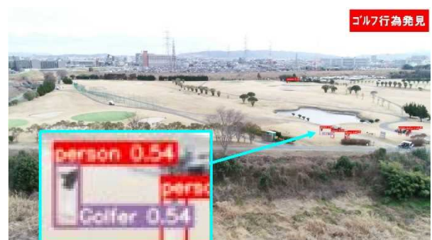
図-14 ドローン映像での検知結果の例(ゴルフ行為)
