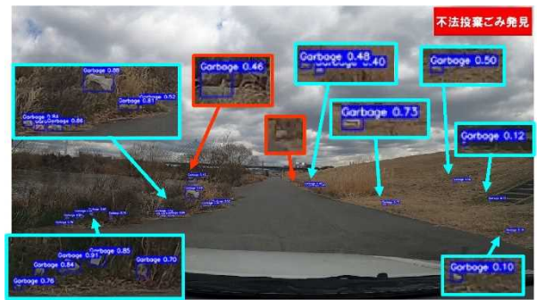
図-11 車載カメラ(正面)映像での検知結果例(不法投棄ごみ)
