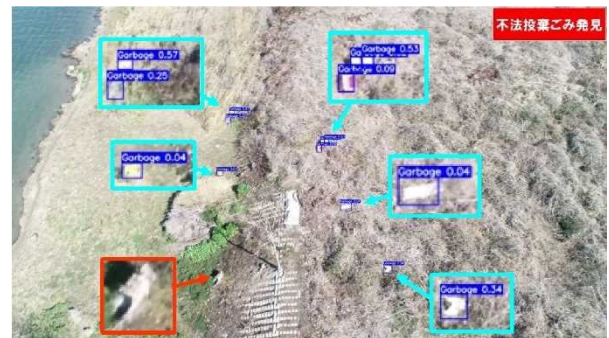
図-13 ドローン映像での検知結果の例(不法投棄ごみ)
