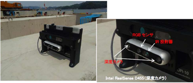
図- 19 ハンディ型 3 次元スキャナーDPI-10SG
