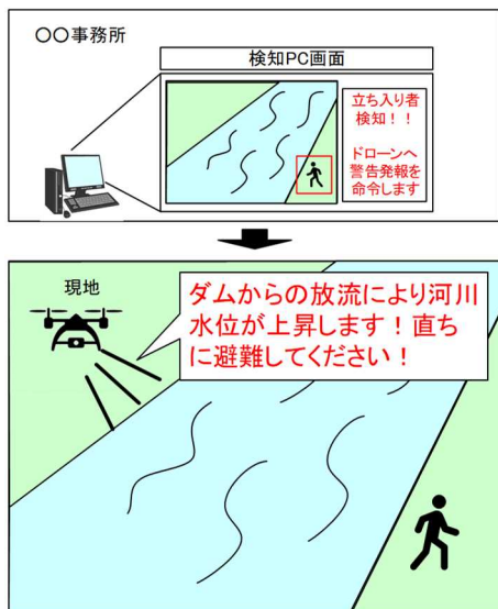
図-15 ドローンと検知モデル（人）を用いた河川パトロールのイメージ
