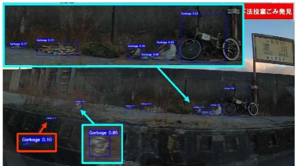
図-12 車載カメラ(側面)映像での検知結果例(不法投棄ごみ)
