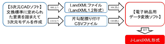
図-11 ソフトCでJ-LandXML形式を作成するフロー
