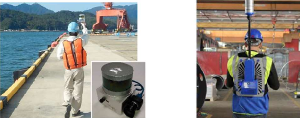
ハンディ型レーザースキャナー Stencil (左) ウェアラブルレーザースキャナーHERON (右) 図- 15 計測イメージ②
