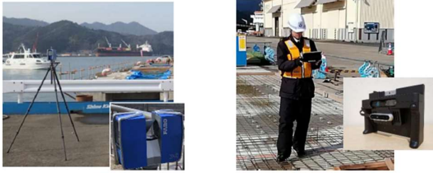
据置型 3 次元レーザースキャナー FARO (左) ハンディ型 3 次元スキャナー DPI-10SG (右) 図- 14 計測イメージ①
