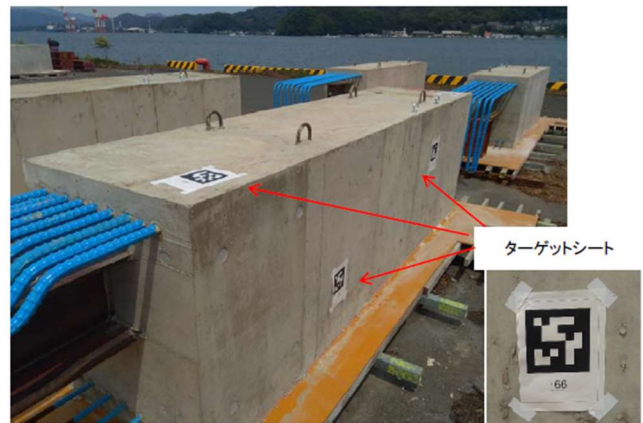
図- 18 計測時梁ブロック
