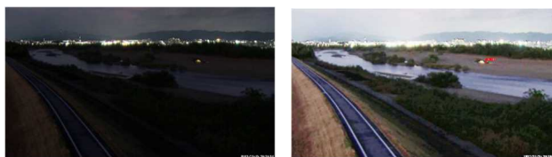
図-4 γ補正の効果 (左:補正前 右:補正後)
