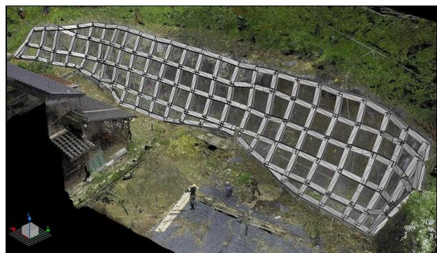
図-3 3次元法枠モデル
