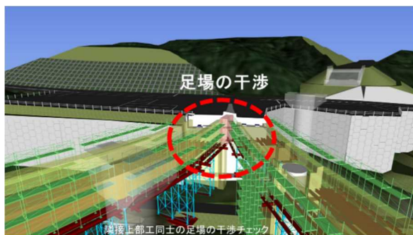
図5 上部工事の足場の干渉チェック
