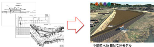
図4 2次元設計図面とBIM/CIMモデル
