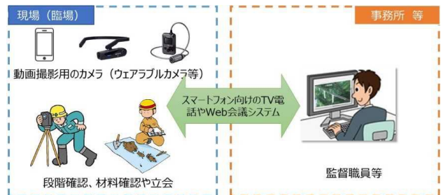
図-13 遠隔臨場機器構成
