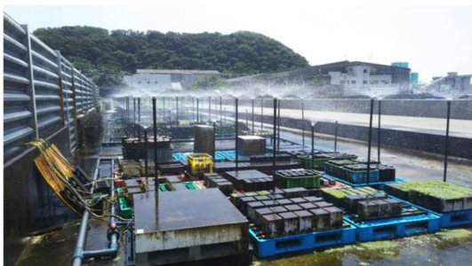
図-2 海水シャワー場（飛沫帯を模擬）
