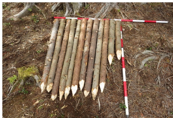
写真-2 試験施工で作成した杭木
