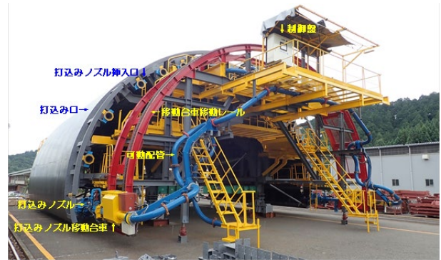
写真-1 マニピュレータ方式自動打込み装置全景
