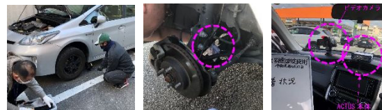
図 6 機器取付状況 (左:ジャッキアップ, 中:加速度計設置, 右:車内機器設置)
