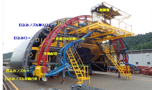
写真-1 マニピュレータ方式自動打込み装置全景
