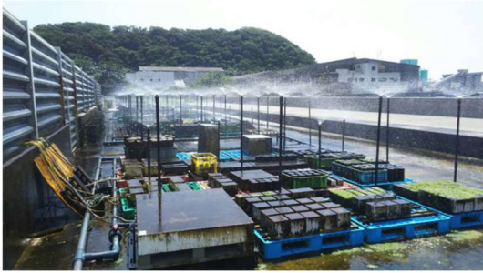
図-2 海水シャワー場（飛沫帯を模擬）
