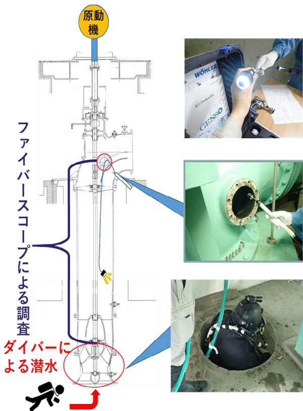
図-5 ポンプ内部の調査
