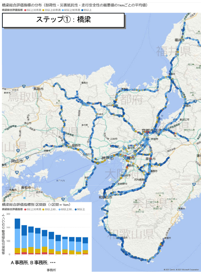
図-7 橋梁の健全性評価結果
