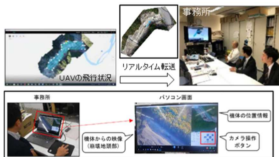
図-7 UAVと遠隔地間での映像共有
