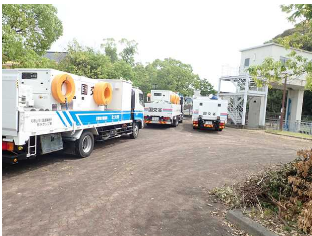
図-3 排水ポンプ車配備
