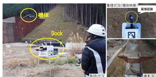
図-8 格納庫を用いた完全自律飛行の検証
