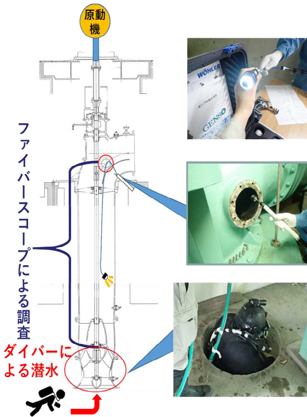
図-5 ポンプ内部の調査
