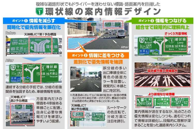
図-5 誤分岐防止に着目した環状線の案内情報デザインのコンセプト
