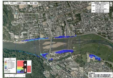
図5-2 確率規模別の浸水想定図 (図は1/10規模の洪水発生時)
