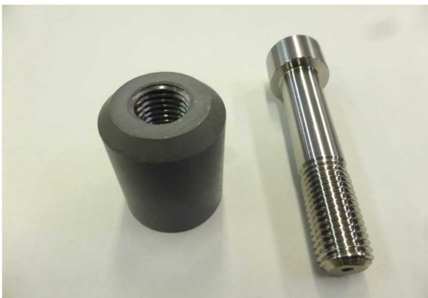
写真4 取付ボルト及びスリーブ
