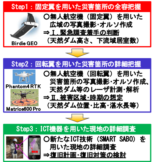
図2 ICT技術を活用した初動対応の実証実験（奈良県五條市赤谷地区）
