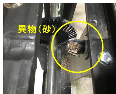
図-9 ラック装置内蔵式の異物噛み込み試験
