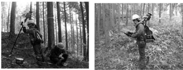
図-1 ①据置型(左)と②歩行型(右)の測定状況写真
