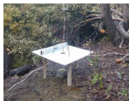
図-6 対空標識の設置
