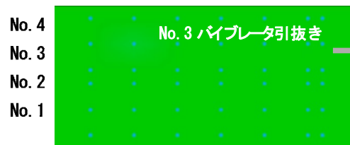
(d) No.3パイプレータ引抜き後(天端部の締固め完了時)
