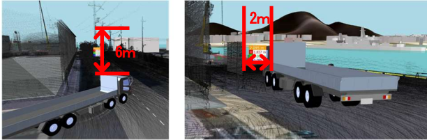
図-15 架空線、既設看板との離隔確認
