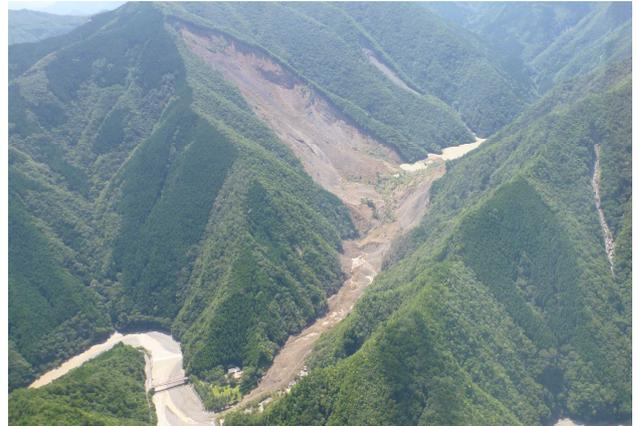
図-1 2011年台風12号による深層崩壊(赤谷地区)
