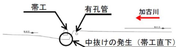
図-13 平成25・26年災 被災後河川縦断面図(河川中心部)
