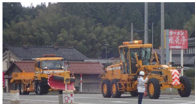
写真-5 梯団を組む近畿地整の除雪グレーダー(前)と北陸地整の除雪トラック(後)
