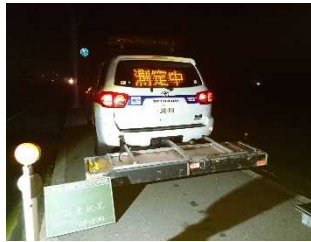
図-11 国道312号の空洞探査
