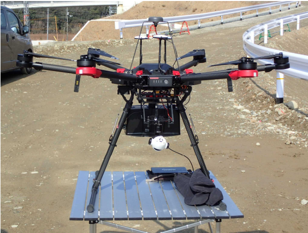
図-2 使用したUAV(レーザスキャナ搭載時)
