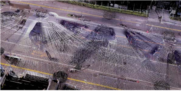
図-6 TLSの画像から作成した路面状況
