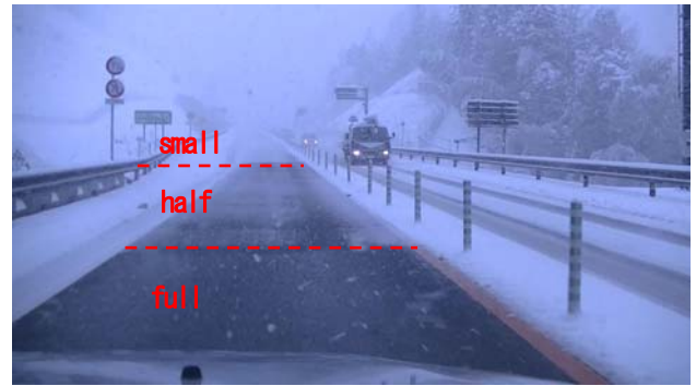
図-2 段階融雪の目視状況
