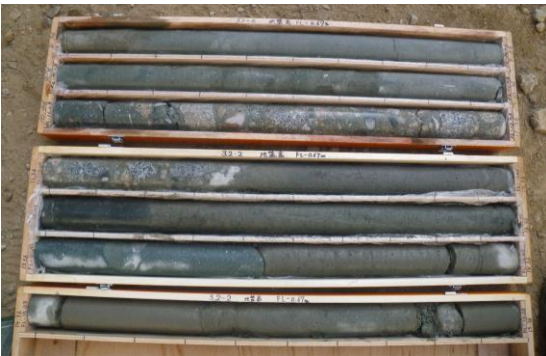
写真-9 ボーリングコア採取状況
