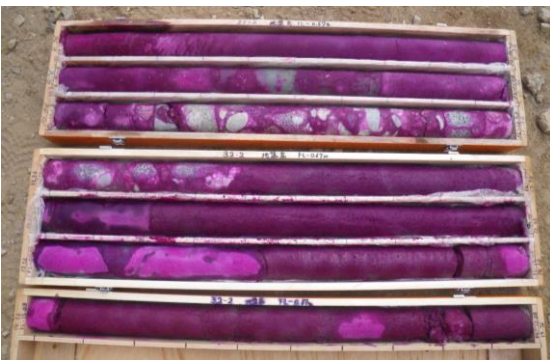
写真-10 フェノールフタレイン液散布状況
