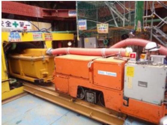
図-7 坑内へ搬入する吸引台車
