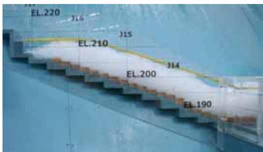
図-22 堤趾導流部の流況(右岸下流面，流量: 1400\text{m}^3/\text{s} )
