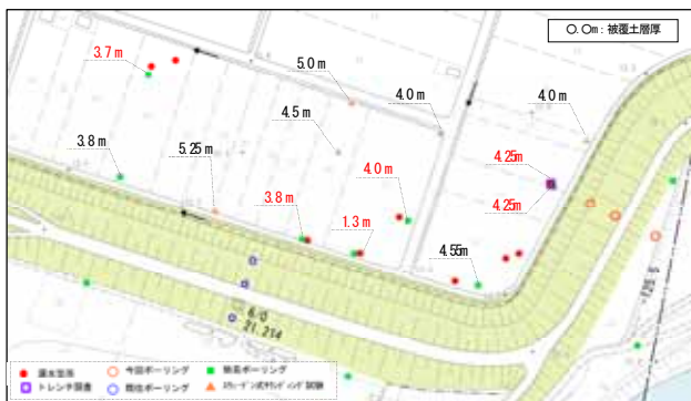
図-9 漏水箇所の粘土層厚 (赤字が漏水箇所)
