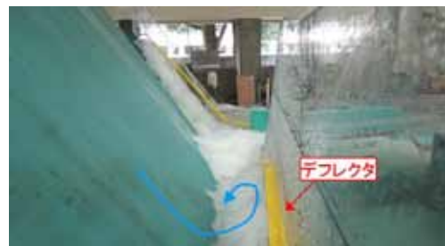
図-19 張り出し長さ1.0mにおける流況
