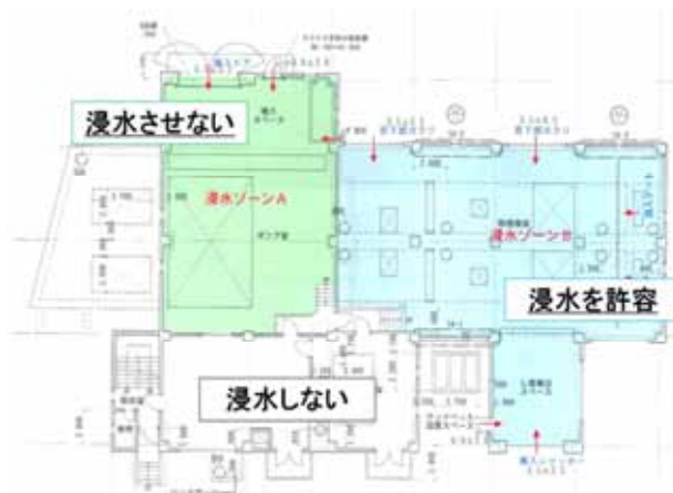
図-6 雨水ポンプ場 重点化区画の設定
