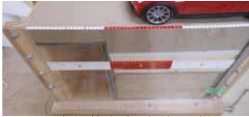
図-2 実験土槽 (写真: 実験初期状態)
