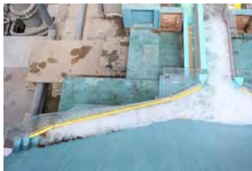
図-23 堤趾導流部の流況(左岸上面，流量: 1400\text{m}^3/\text{s} )
