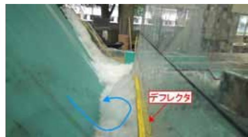
図-18 張り出し長さ0.5mにおける流況
