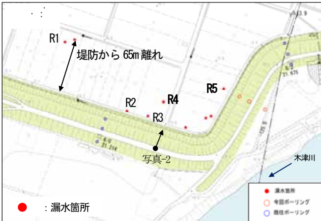
図-4 主な漏水箇所 (久御山町久御山地区)
