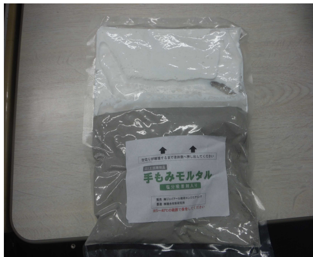
写真-11 手もみモルタル
